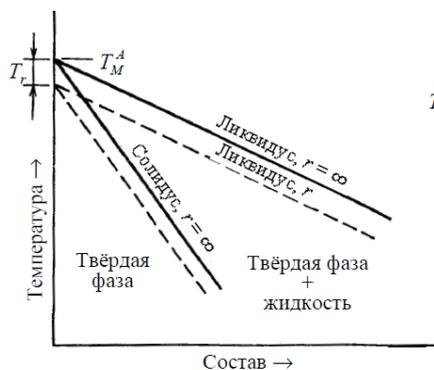
Рис. 2. Сдвиг равновесных кривых ликвидуса и солидуса, когда поверхность твёрдой фазы имеет радиус кривизны  $r$ .
