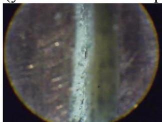
Рис. 2. Изображение поверхности мишени после напыления оксидов титана и бария
