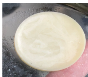
Рисунок 2. Ненаполненная плёнка лестосила
