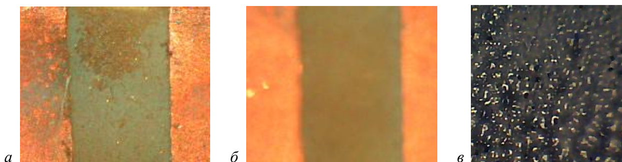
Рисунок 2. Изображение поверхности мишени после напыления оксидов меди сериями двоянных лазерных импульсов: a – 150 импульсов; б – 3×250 импульсов, в – напыление на стекле, увеличение 375 раз
