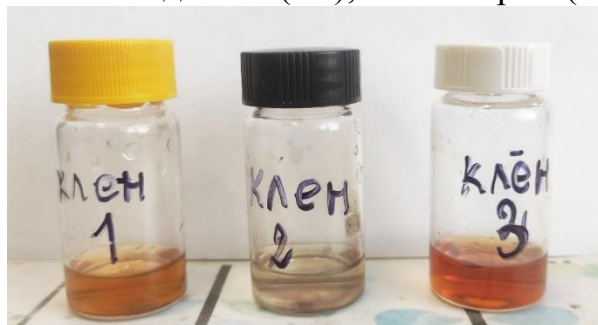
Рис. 1 Фото водных экстрактов листьев клена с различным соотношением объем водного экстракта/ \text{Ag}^+ 1:1; 1:0,5; 1:2 через 20 мин после приготовления (слева направо)
