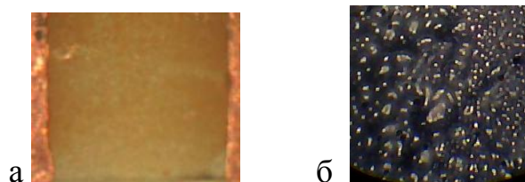
Рис. 2. Изображение поверхности мишени после напыления оксидов меди сериями сдвоенных лазерных импульсов: а – 3 \times 150 импульсов; б – напыление на стекле, увеличение 375 раз
