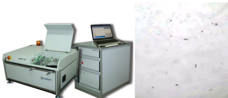
Рис. 1. Изображение рабочей установки (а) и поверхности стекла после напыления пленки сдвоенными лазерными импульсами (б)
