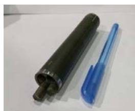
Рисунок 4. а) Схема укладки образцов из стали 08X18H10T и 09X17H в контейнер для диффузионной сварки: 1 - сборка 08X18H10T – 09X17H с обработанными поверхностями; 2 - контрольная сборка 08X18H10T – 09X17H (без лазерной обработки); 3 - тонкостенный контейнер; 4 - крышка контейнера; б) фото сваренной заготовки с вырезанными из нее образцами для механических испытаний.
