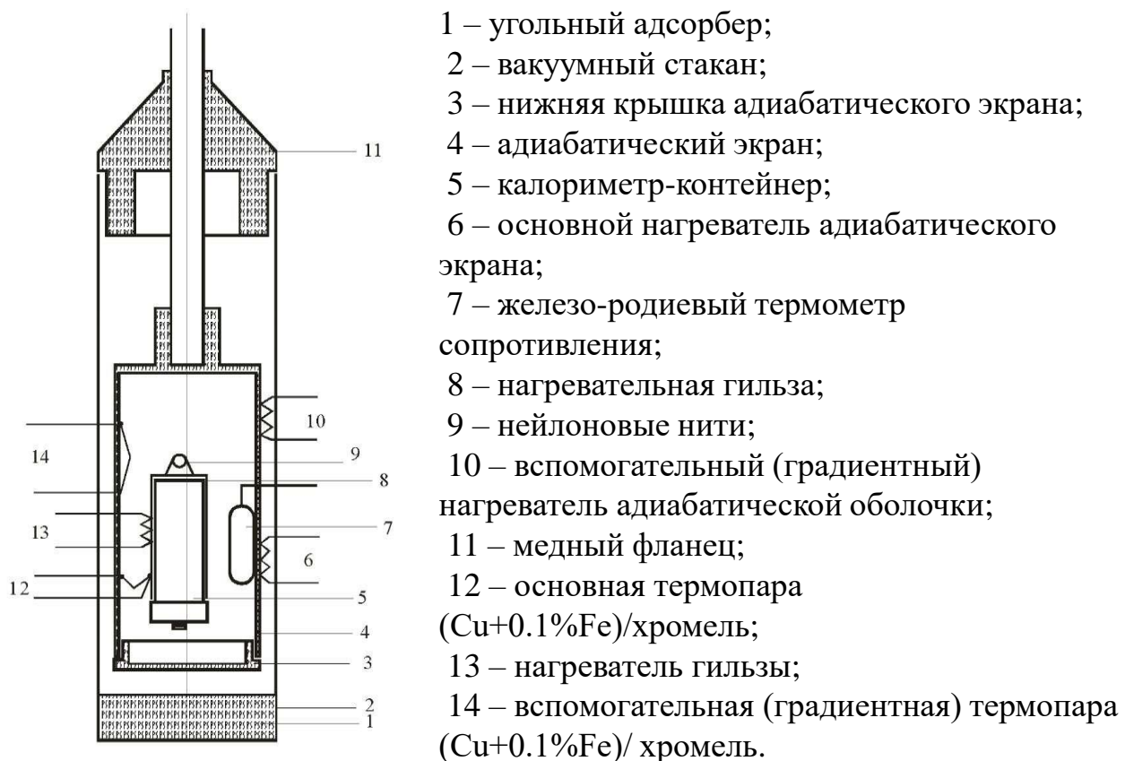
Рисунок 1 – Принципиальная схема калориметра ТАУ-10
