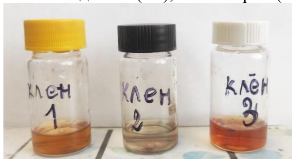
Рис. 1 Фото водных экстрактов листьев клена с различным соотношением объем водного экстракта/Ag + 1:1; 1:0,5; 1:2 через 20 мин после приготовления (слева направо)
