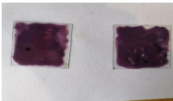
Рис. 1. Вид элементов с матрицей из оксида титана и агар-агара.
