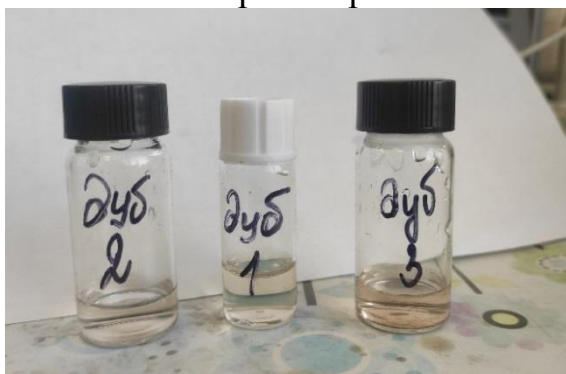
Рис. 1. Водные экстракты листьев дуба, собранных на ул. Троицкой, через 15 мин и 1 день после добавления \text{AgNO}_3 (слева направо). Соотношение объема экстракта и \text{Ag}^+ : 1/0,5; 1/1; 1/2
