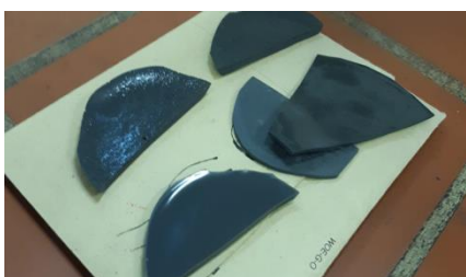
Рис 1. Наполненная плёнка лестосила.
