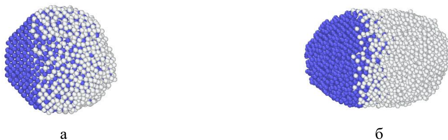
Рис. 2. Результаты моделирования процесса нагревания в нанокластере Nb-Al: а – использовался ЕАМ-потенциал (шаг 0.1 фс), б – МЕАМ-потенциал (шаг 0.2 фс).
